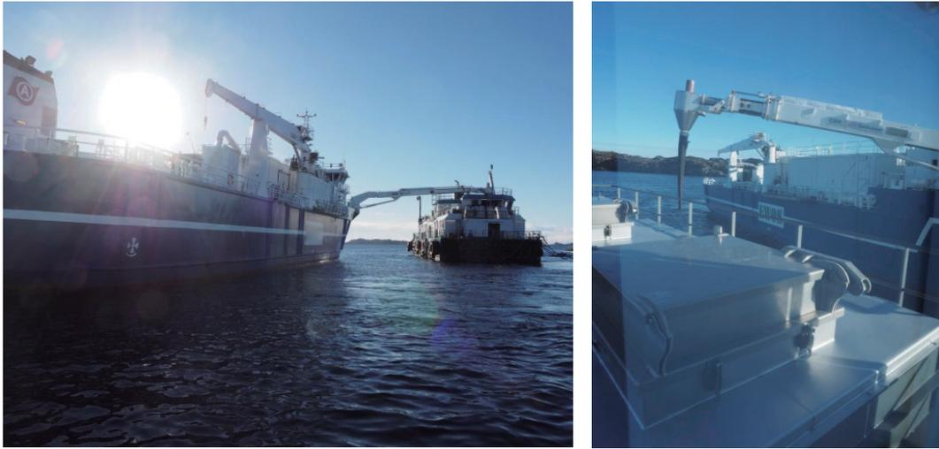
写真 13 飼料メーカーの配送船によるフィードバージへの飼料の積込
